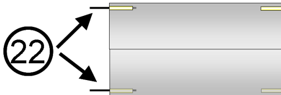
Grafik 1.7.2 Anbringung des Federstahls in den Scharnierröhrchen
